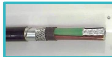
Câble papier triphasé à gaine d'aluminium extrudée
